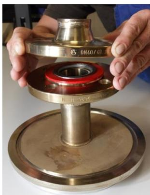
Abb.1: Prüfflansche DN40 PN40
