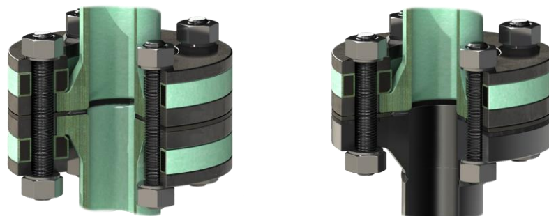
Abb.7: regelkonforme, betriebssichere GFK-Flanschverbindungen nach Stand der Technik © Peter Thomsen - www.thomsen-bremen.de
