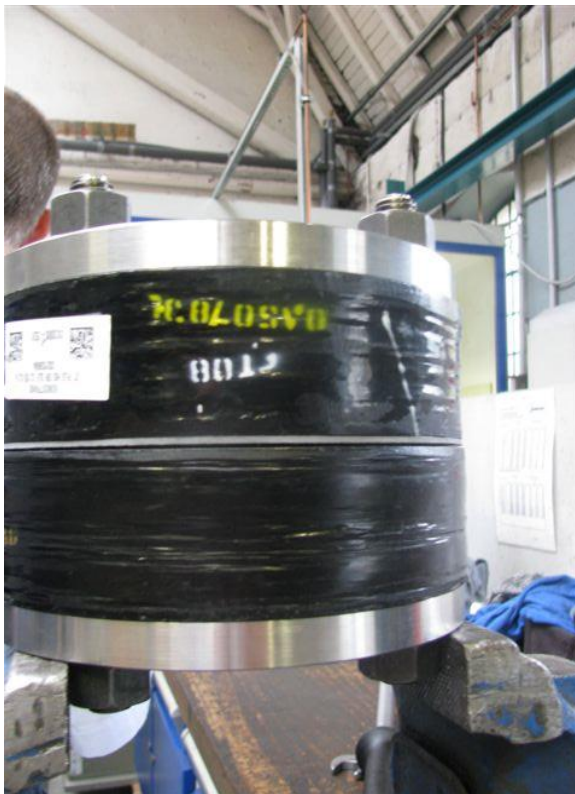
Abb.3: Gesamtansicht der Verbindung, in der Mitte ist der Stützring des Dichtelements zu erkennen
