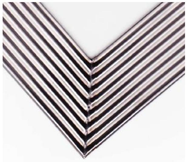
**Abb.2: Rahmenecke lasergeschweißt**
