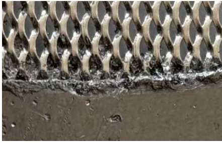
Bild 1: Grafitdichtung mit Streckmetalleinlage (Bild: Peter Thomsen)
