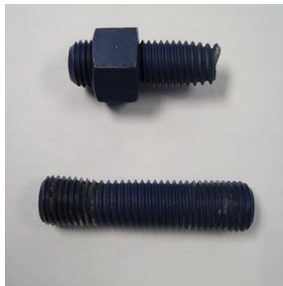
Abb.8: Folge nicht angepasster Drehmomente bei Veränderung der Oberflächenbeschichtung
