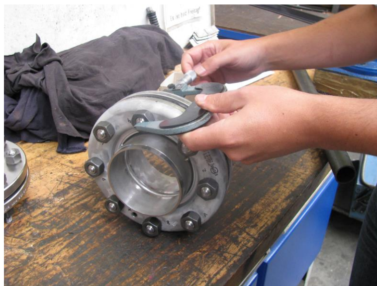
Abb.4: Messung der Schraubenlänge mit Micrometer
