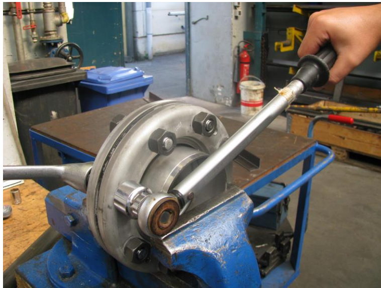
Abb.3: Montage der Schrauben mit Drehmomentschlüssel
