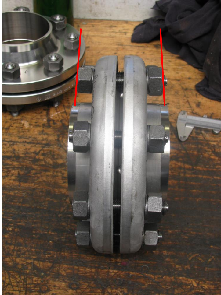
Bild 7: Durchbiegung der Schrauben durch Flanschrotation bei 180 Nm
