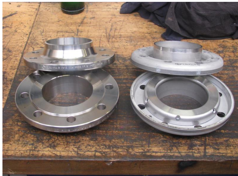
Abb.1: Flansche DN100 PN16, links Schmiedeflansche (ca. 5 kg/Stück), rechts Pressflansche (ca. 3 kg/Stück)
