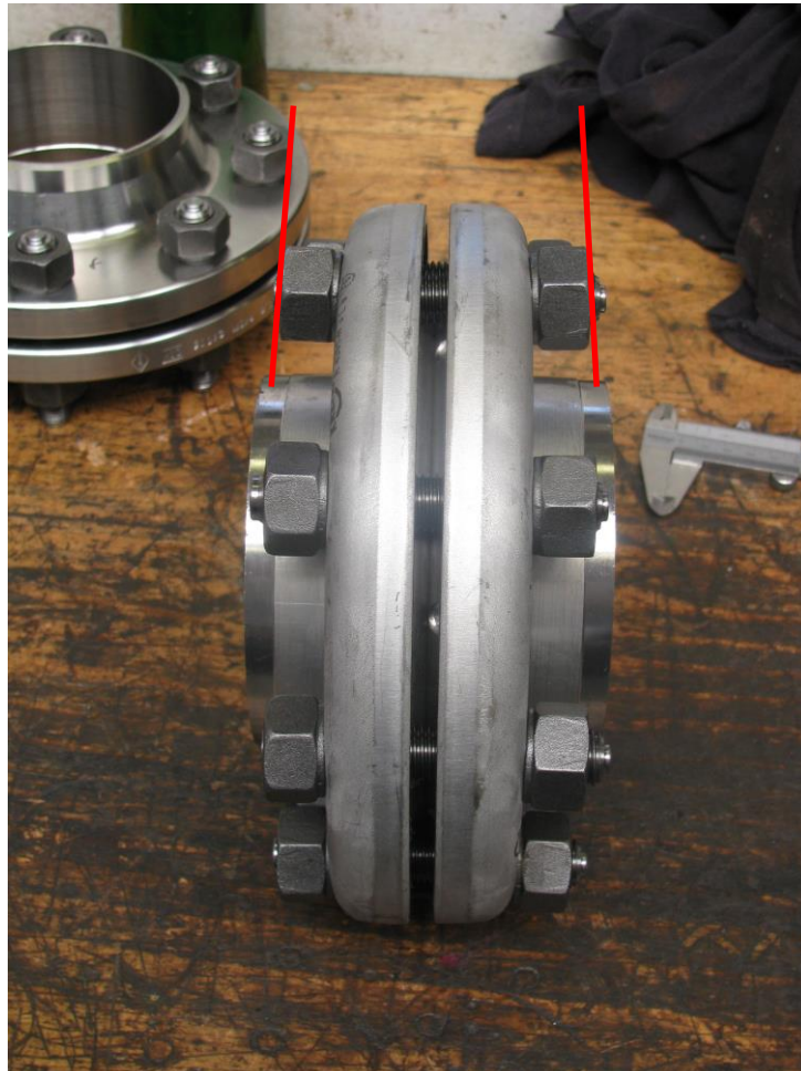
Bild 7: Durchbiegung der Schrauben durch Flanschrotation bei 180 Nm
