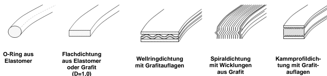
Abb.4: Dichtungen die für den Einsatz im Kraftnebenschluss geeignet sind
